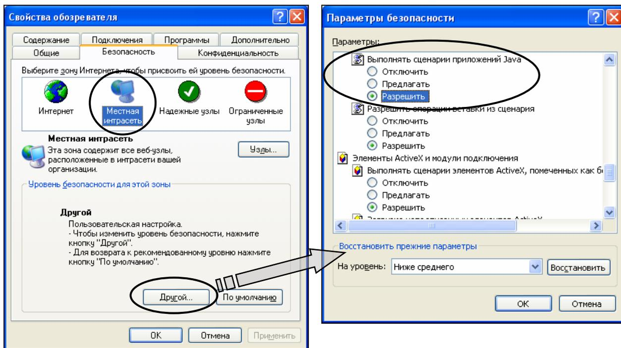
Рис. П2.11. Настройка браузера Internet Explorer на клиентских компьютерах: разрешить выполнение Java-скриптов при работе в местной интранети
