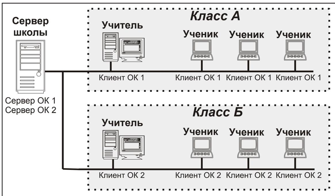
Рис. П2.6. Организация работы с сетевыми версиями образовательных комплексов (ОК 1, ОК 2) при наличии единого сервера локальной сети образовательного учреждения
