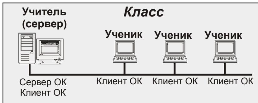
Рис. П2.5. Организация работы с сетевыми версиями образовательных комплексов (ОК) в случае, когда сервер размещен на компьютере учителя
