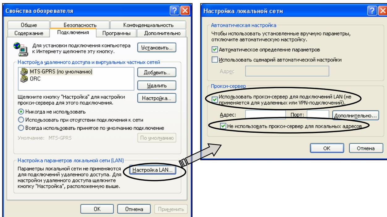
Рис. П2.12. Настройка браузера Internet Explore на клиентских компьютерах: отключить использование прокси-сервера для локальных адресов интранета
